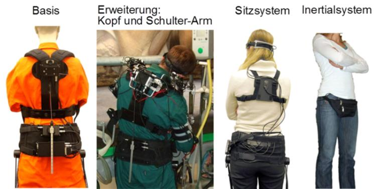
Verschiedene Varianten des CUELA-Messsystems: Basissystem, Erweiterung Kopf und Schulter-Arm-Bereich, Sitzsystem und Inertialsystem
