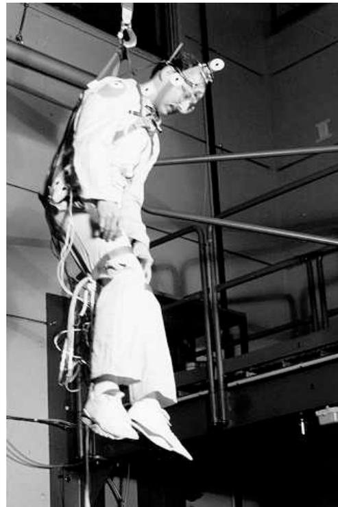
Im Auffanggurt gehaltene Versuchsperson nach einem Absturz aus 1,5 m Höhe, ausgestattet mit Messeinrichtungen und Sensoren zur Erfassung der Verzögerungskräfte und Bewegungen
