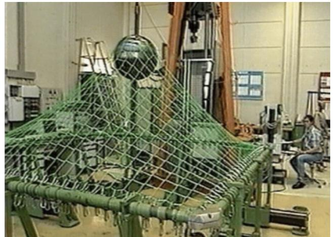
Ermittlung der Energieaufnahmefähigkeit eines Schutznetzes im statischen Versuch
