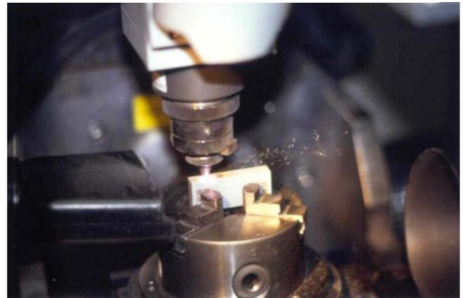
Rauchentwicklung bei der Materialbearbeitung mit Laserstrahlung
