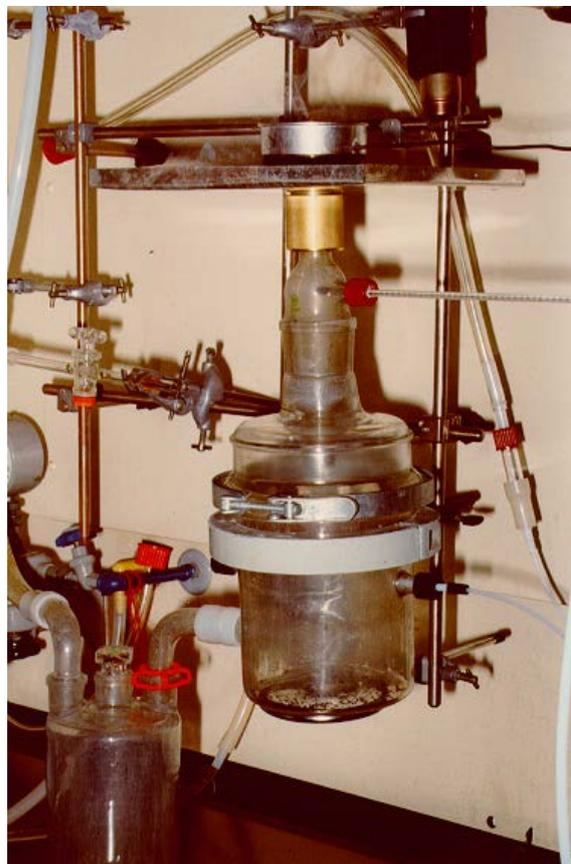
Apparatur zur Untersuchung des Brandverhaltens von Atemschutzfiltern
