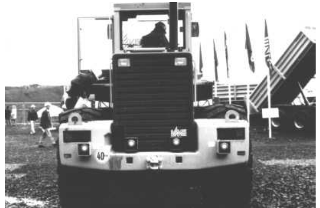
Ultraschallsensoren der Rückfahr-Warneinrichtung am Radlader
