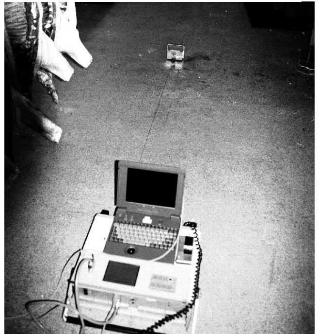
Messung der Rutschhemmung des Bodens im Kühlraum eines Fleischereibetriebes
