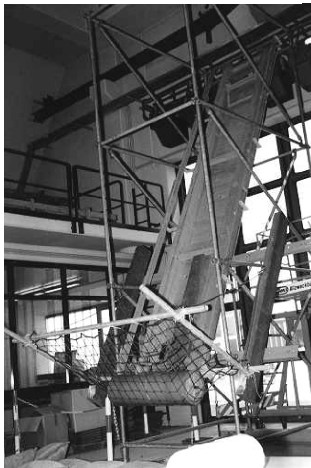
Abrollprüfstand mit Stahlrohrrahmen und Schutznetz als Prüfmuster
