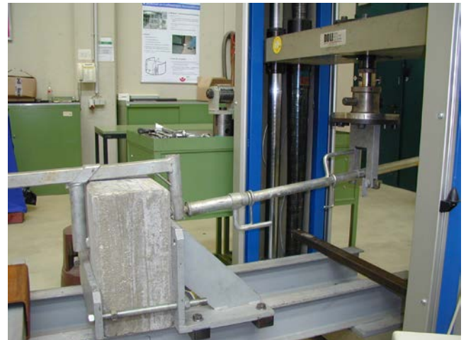
Seitenschutzpfosten mit Klemmfuß für Deckenkante unter der Prüfmaschine
