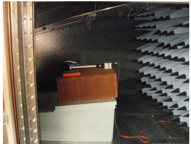
Prüfung der Beeinflussung von Steuerungen durch hochfrequente elektromagnetische Felder
