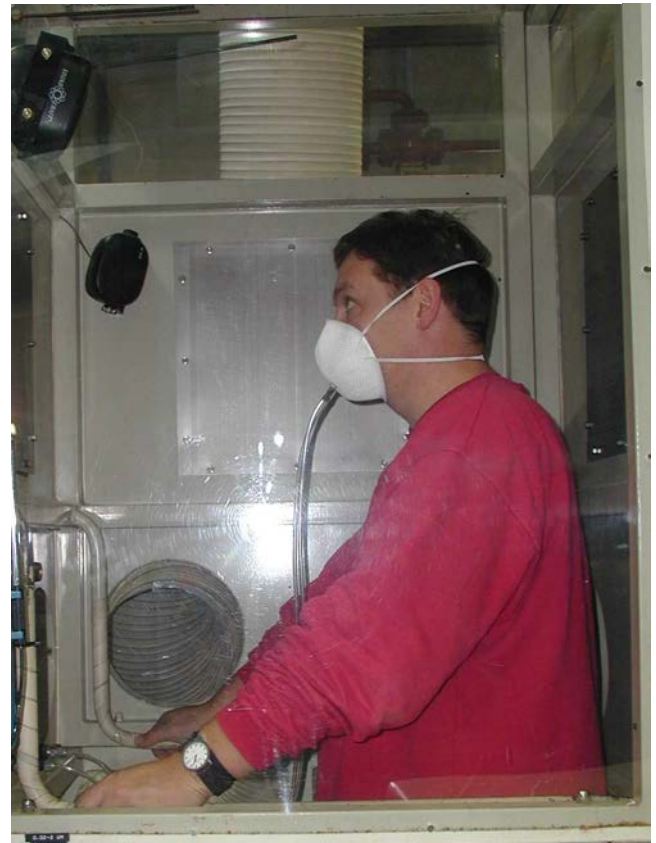
Messung der Leckage einer Staubmaske
