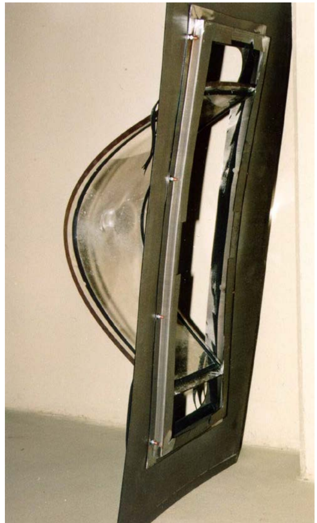
Sichtscheibe, die beim Aufprall von Teilen aus der Befestigung gerissen wurde
