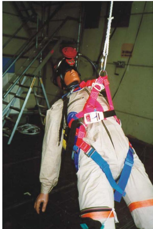
Dummy in einem Auffangsystem. Die Atemschutzmaske wurde beim Auffangvorgang durch die vordere Fangöse hochgeschoben und saß nicht mehr dicht. Es besteht auch das Risiko von Gesichtsverletzungen.
