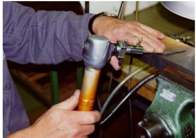
Elektrisches Handfeilgerät, Vibrationseinleitung über das Einsatzwerkzeug Feile
