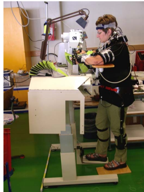
Der neu entwickelte ergonomische Näharbeitsplatz, Näherin ausgerüstet mit CUELA-Messsystem
