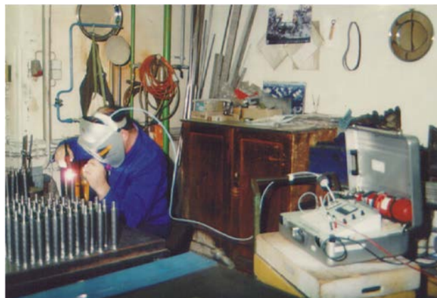
Messung der Ozonbelastung bei Schweißarbeiten
