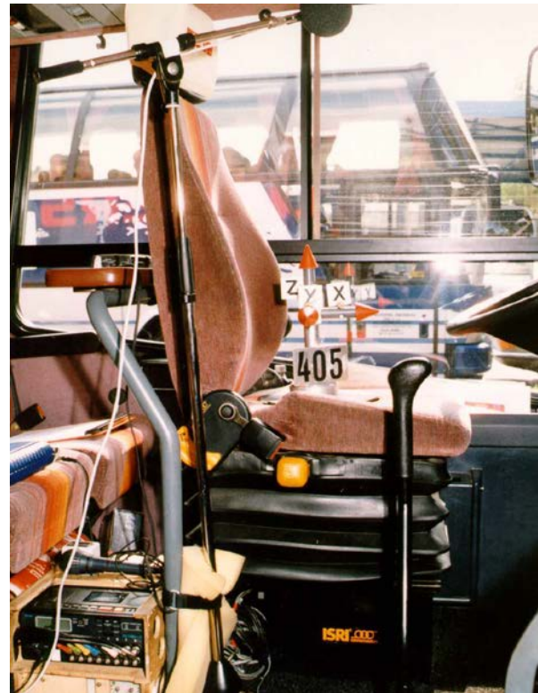
Fahrerarbeitsplatz im Reisebus mit Messausrüstung
