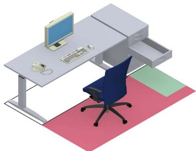
Abb. 13 Zulässige Überlagerung von Bewegungs-/ Benutzerflächen und Funktionsfläche
