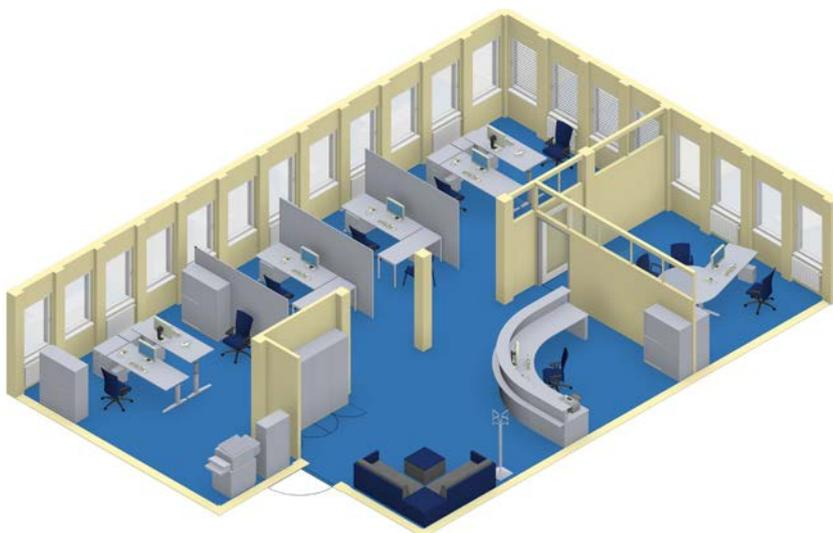
Ein durchgehender Be-diengang sichert die Er-reichbarkeit der Bedien-elemente für Heizkörper, Fenster und Sonnenschutz für die Beschäftigten. We-gen der über Eck verlaufen- den Fensterfronten muss besonders auf geeigneten Sonnenschutz zur Blen-dungsbegrenzung geachtet werden.
