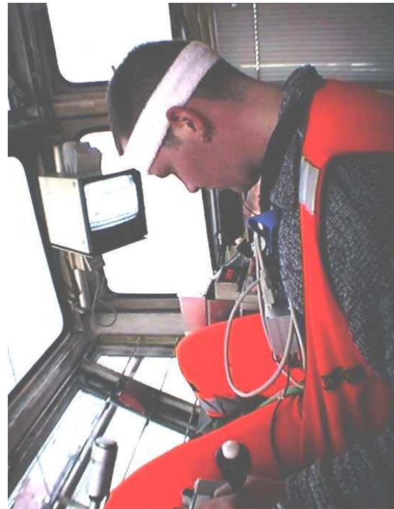
Brückenführer mit personengetragendem Messsystem in typischer Arbeitshaltung
