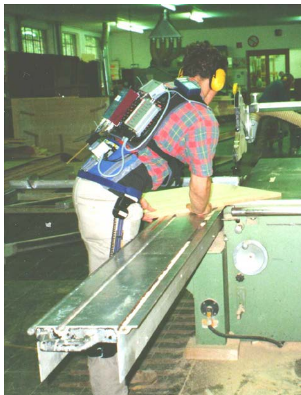
Arbeiten an einer Kreissäge, Bewegungserfassung mit dem Messsystem CUELA
