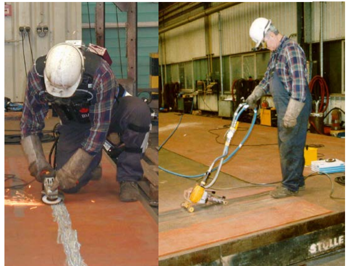
Bearbeitung von Schweißnähten mit handgehaltenem Winkelschleifer (links) und handgeführtem Bandschleifer (rechts)
