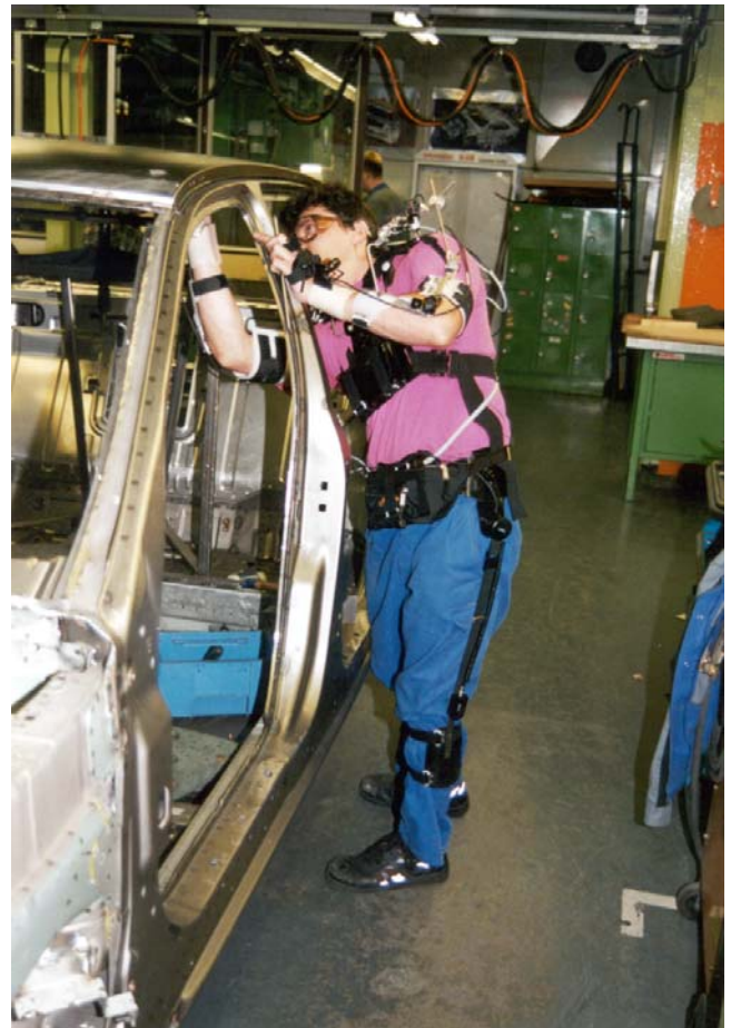
Bewegungserfassung an einem Montagearbeitsplatz
