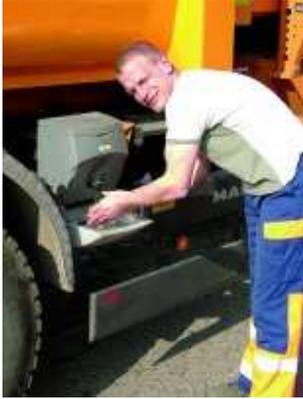
**Abb. 8-1: Mobiles Waschbecken zur Anbringung außen am Fahrzeug**
