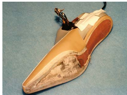
Bearbeitung des Oberledermaterials mit Anklopfmaschine in der Schuhproduktion, Anbringung des Beschleunigungsaufnehmers am Leisten
