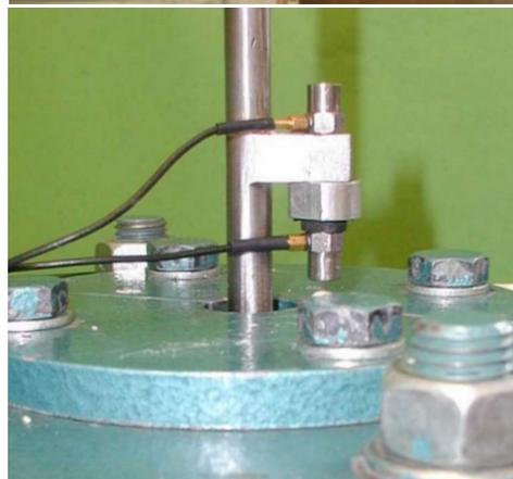
Vergleichsmessung piezoelektrischer Beschleunigungsaufnehmer mit Laser-Vibrometer
