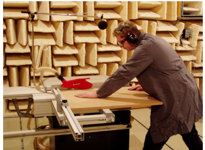
Bestimmung der Geräuschemission beim Sägen im Semi-Schallschluckraum
