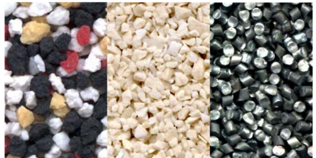
Beispiele für nicht silikogene Strahlmittel (von links: Kunststoff, Keramik, Stahldrahtkorn, Bildhöhe ca. 0,5 cm)
