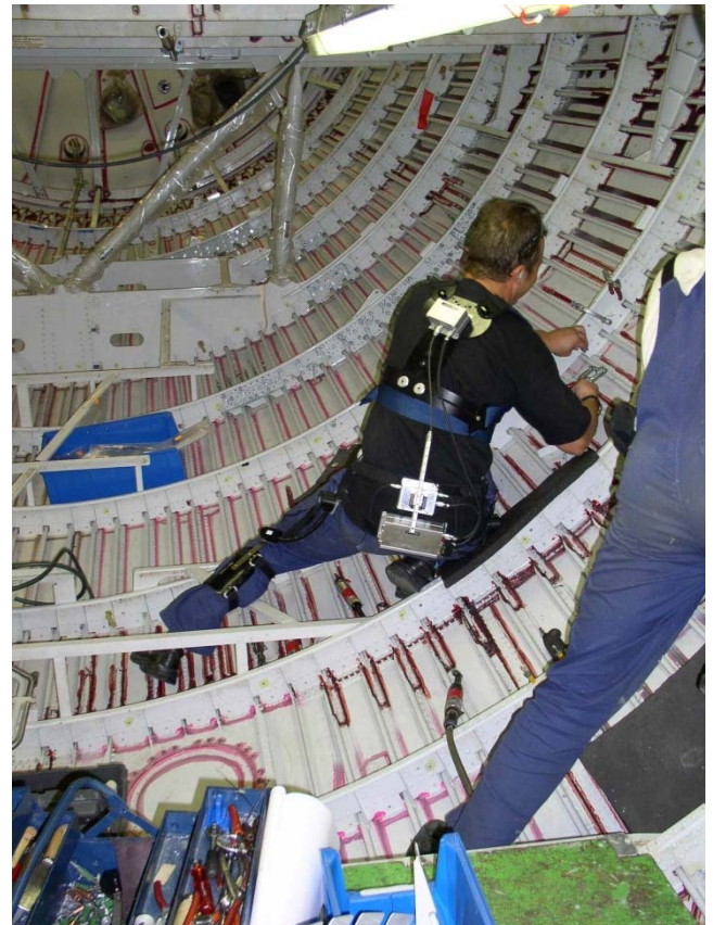
Bewegungserfassung an einem Flugzeugmechaniker beim Auswechseln von Spanten
