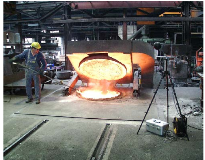
Kontrolle der Schmelze an einem Tiegelofen
