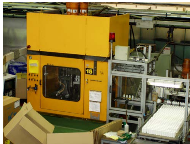
Hohlkörperblasmaschine mit um 1 m erhöhter Abschirmung
