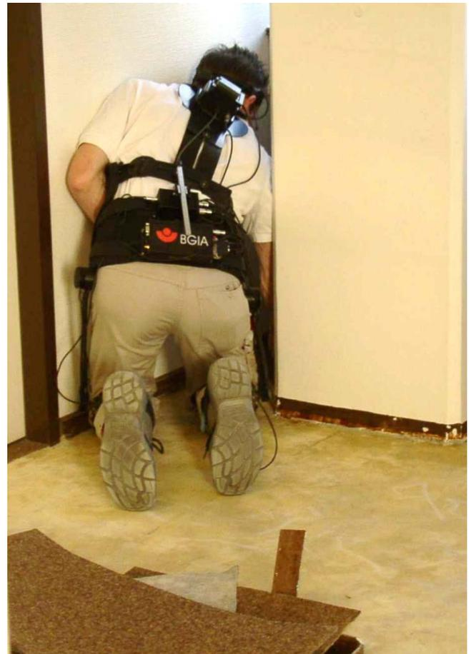
Raumausstatter mit CUELA-Messsystem in typischer Arbeitssituation: Entfernen von altem Bodenbelag
