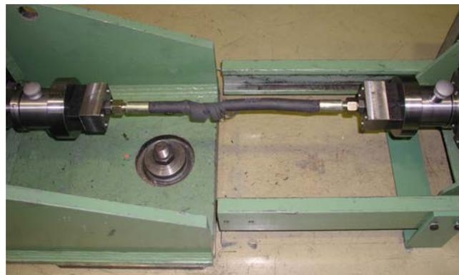
Versuchsaufbau zur Ermittlung der Ausreißkraft
