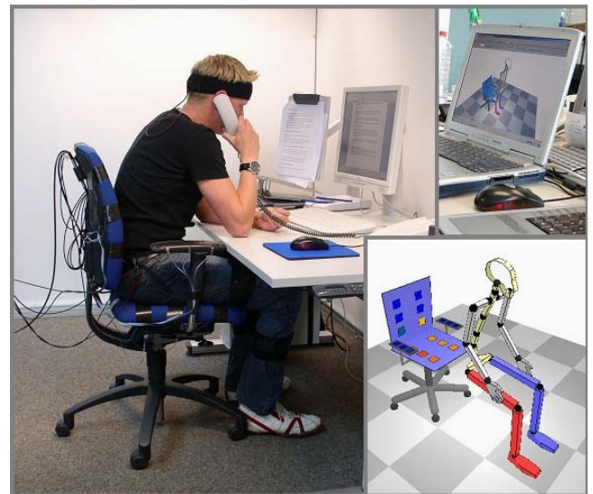
Messung an nachgestelltem Büroarbeitsplatz in Laborumgebung, Darstellung in der CUELA-Software
