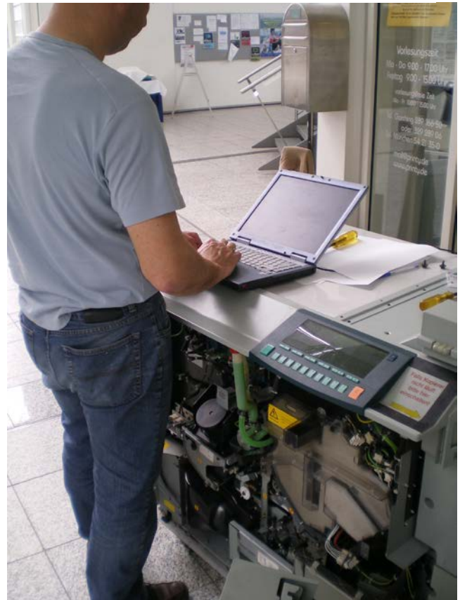
Laptop-Einsatz bei der Wartung eines Kopierers
