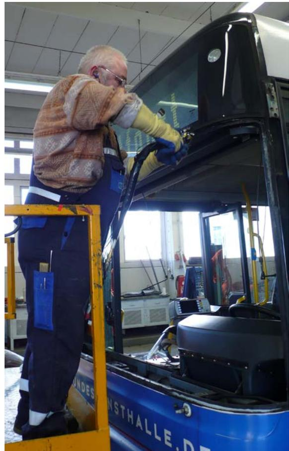
Einsatz eines Oszillationsmessers beim Frontscheibenwechsel eines Omnibusses
