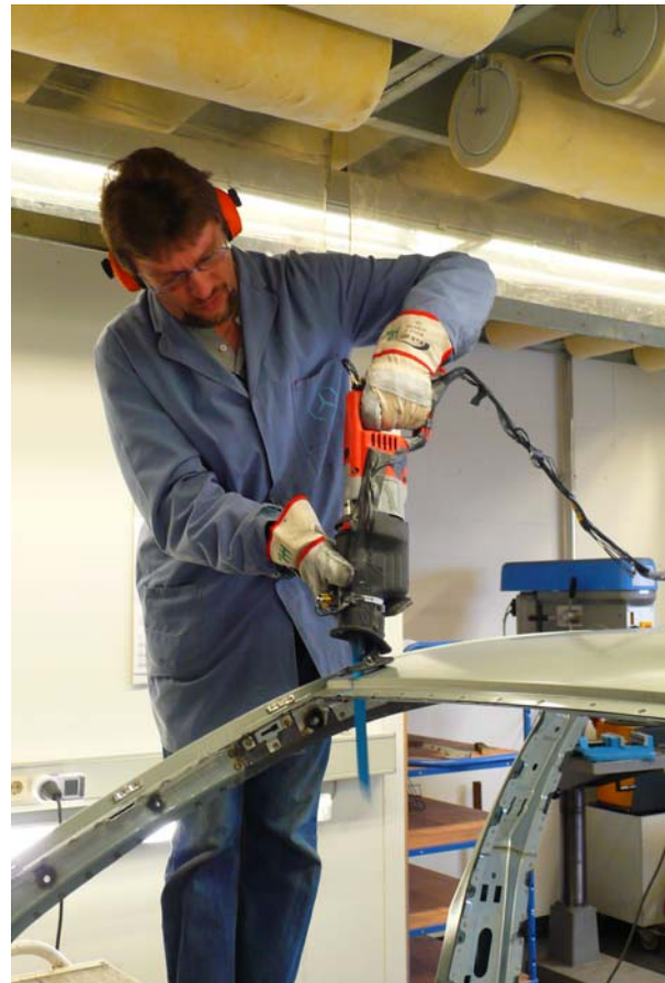
Einsatz einer Säbelsäge in der Metallverarbeitung
