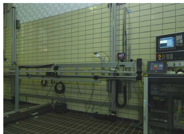
Rangier-Warneinrichtung mit Kamera-Monitor-System (oben), IFA-Prüfstand für Sensorsysteme zur Personendetektion (unten)
