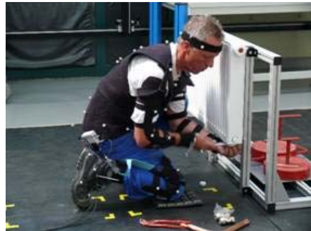
Installateur bei der Heizkörpermontage im Labor
