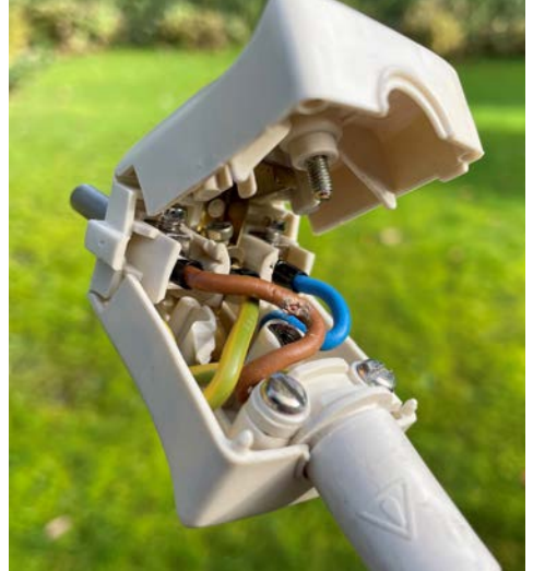
Abb. 10 Beispiel eines Isolationsfehlers aufgrund einer fehlerhaften Montage
