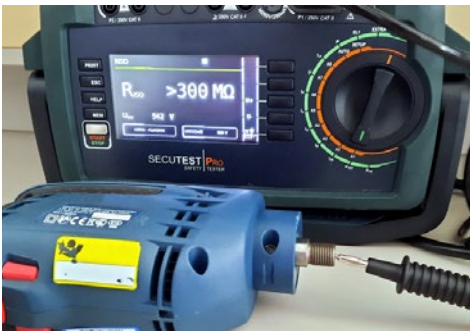
Abb. 39 Prüfgerät mit Prüfbläufen für verschiedenste Betriebsmittelarten. Der Prüfablauf kann automatisch oder manuell gesteuert werden
