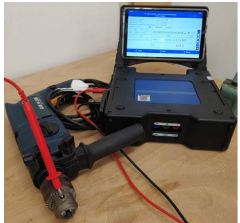
Abb. 40 Smartphonegesteuertes Prüfgerät mit Datenbankanbindung
