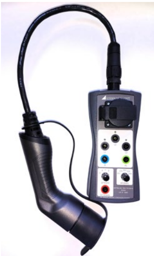
Abb. 55 Prüfadapter zur Simulation der Fahrzeugzustände
