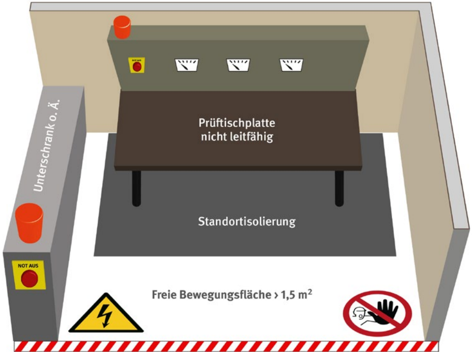
Abb. 42 Beispiel für einen Prüfplatz in einer Elektrowerkstatt
