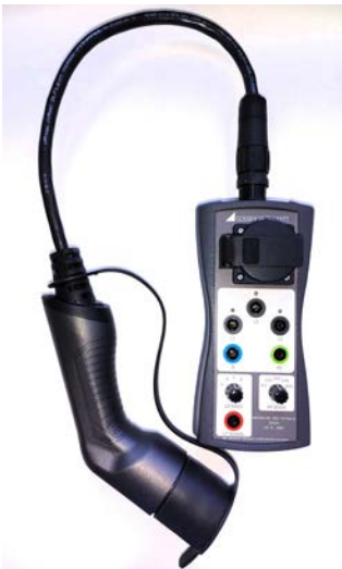
Abb. 55 Prüfadapter zur Simulation der Fahrzeugzustände
