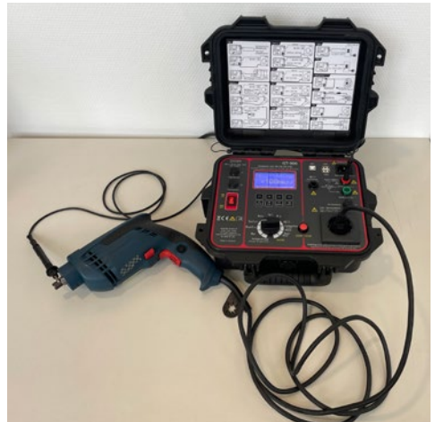
Abb. 32 Prüfgerät für die Geräteprüfung nach VDE 0701 und VDE 0702; Schutzleiterprüfstrom 10A
