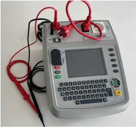
Abb. 37 Prüfgerät mit erweitertem Prüfumfang (u. a. Schutzleiterstrommessung mit 200 mA, 10 A oder 25 A; Hochspannungsprüfung mit 1,5 oder 3 kV AC). Prüfbläufe können sowohl geräte- als auch nutzerbezogen gesteuert werden
