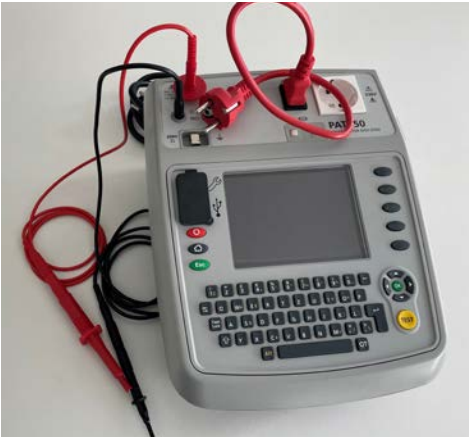
Abb. 37 Prüfgerät mit erweitertem Prüfumfang (u. a. Schutzleiterstrommessung mit 200 mA, 10 A oder 25 A; Hochspannungsprüfung mit 1,5 oder 3 kV AC). Prüfabläufe können sowohl geräte- als auch nutzerbezogen gesteuert werden
