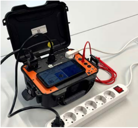
Abb. 33 Prüfgerät mit Steuerung über Smartphone. Über die Kamera des Smartphones können sowohl Barcodes eingelese als auch Fotos des Prüflings abgespeichert werden
