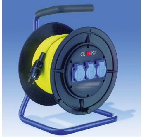
Abb. 58 Kennzeichnung der Anwendungskategorie an den Betriebsmitteln, hier K2 (DGUV Information 203-005)
