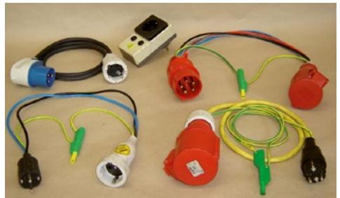
Abb. 44 Verschiedene Prüfadapter, u. a. zum Anschluss von Drehstrom-Prüflingen sowie zur Schutzleiter- und Berührungsstrommessung
