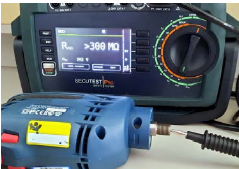
Abb. 39 Prüfgerät mit Prüfabläufen für verschiedenste Betriebsmittelarten. Der Prüfablauf kann automatisch oder manuell gesteuert werden
