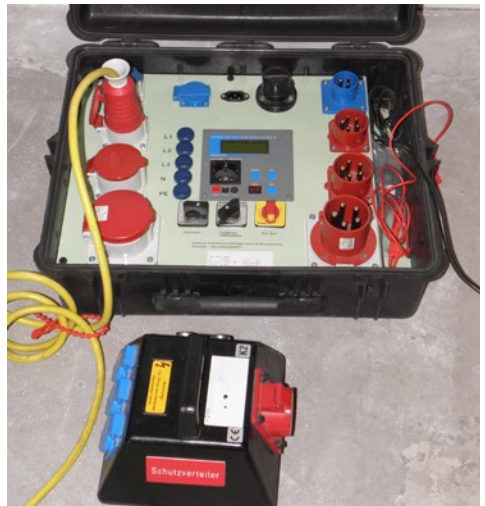
Abb. 36 Mobiles Prüfgerät für Verlängerungsleitungen und elektrische Betriebsmittel mit automatischem Gerätetester zur Prüfung nach VDE 0701 und VDE 0702
