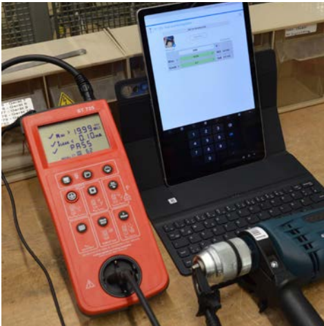
Abb. 31 Prüfgerät für die Geräteprüfung nach VDE 0701 und VDE 0702, das sowohl im Akkubetrieb als auch mit Netzspannungsvorsorgung betrieben werden kann
