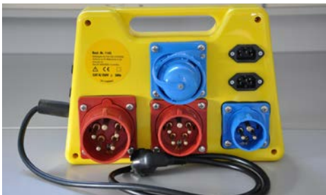
Abb. 43 Prüfadapter für Prüflinge mit Steckvorrichtungen, wie CEE-Norm 3~/400V/50 Hz oder 3~/200V/300 Hz o. Ä., die nicht direkt an ein herkömmliches Prüf-/Messgerät anschließbar sind
