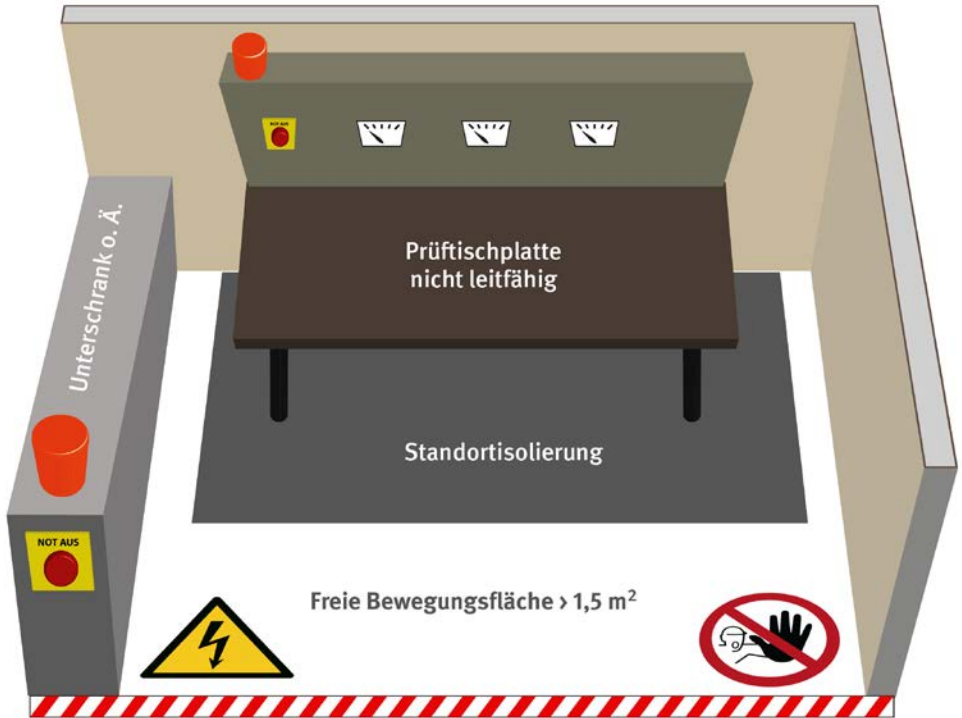
Abb. 42 Beispiel für einen Prüfplatz in einer Elektrowerkstatt
