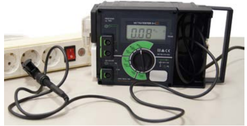
Abb. 38 Prüfgerät mit manuellem Prüfablauf. Zusätzliche Eigenschaften: Separate Steckdosen für jeweils Prüf- bzw. Netzspannung zur Durchführung von Strommessungen nach der alternativen Methode oder der Differenzstrommethode sowie zur Funktionsprüfung an Netzspannung
