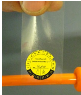
Abb. 27 Prüfbänderole zur Befestigung an der Anschlussleitung
