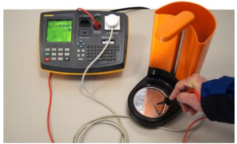
Abb. 34 Prüfgerät mit Tastatur, über die eine große Anzahl nummernkodierter Prüfsequenzen angewählt werden können. Zusätzlich besteht eine Anschlussmöglichkeit für die Prüfung von Kaltgeräteleitungen
