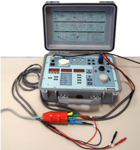
Abb. 35 Prüfgerät für die Geräte- und Maschinenprüfung gemäß VDE 0701 und VDE 0702 und VDE 0113. Zusätzliche Eigenschaften (u. a.): Schutzleiterprüfung mit bis zu 25A Prüfstrom, Hochspannungstest mit bis zu 5,1kV, Restspannungsmessung, Netz/Schleifenimpedanzmessung und Prüfung von RCDS
