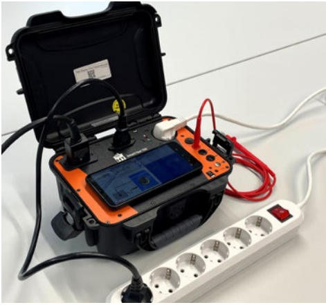
Abb. 33 Prüfgerät mit Steuerung über Smartphone. Über die Kamera des Smartphones können sowohl Barcodes eingelesen als auch Fotos des Prüflings abgespeichert werden
