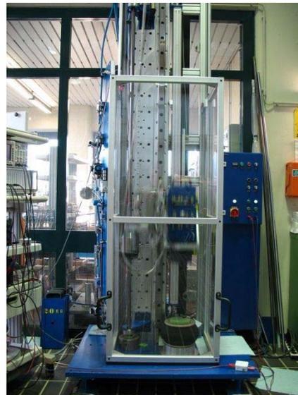
Prüfstand für lineare Bremsen
