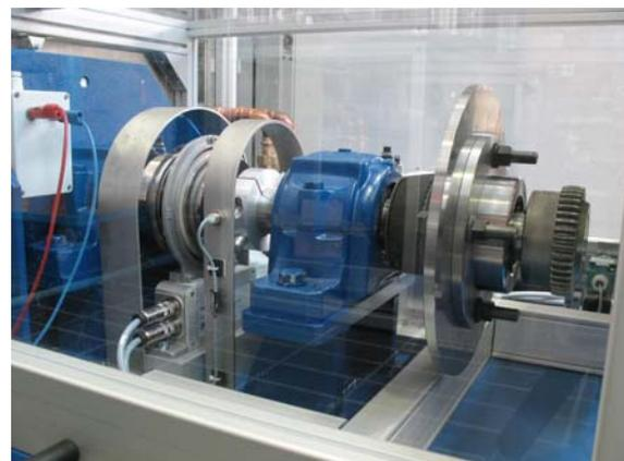
Prüfstand für rotatorische Bremsen
