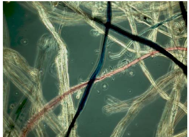
Abgelagerter Staub aus dem Bereich Papiergeldbearbeitungsmaschine in einer Geldsammelstelle
