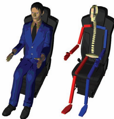
Anpassung eines Menschmodells zur Ermittlung ergonomischer Sitzhaltungen im Linienbus
