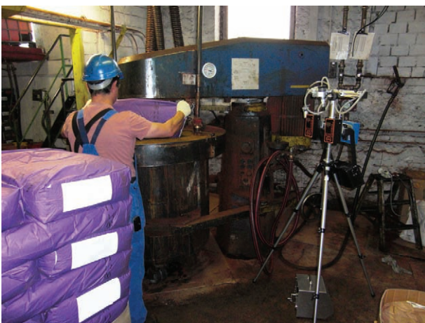
Messung nanoskaliger Partikel beim Einfüllen von Pigmenten (Quelle: Fa. Brockhues GmbH & Co. KG, Walluf)
