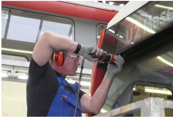
Messung der Hand-Arm-Vibration an einem Oszillationsmesser in der Instandsetzung
