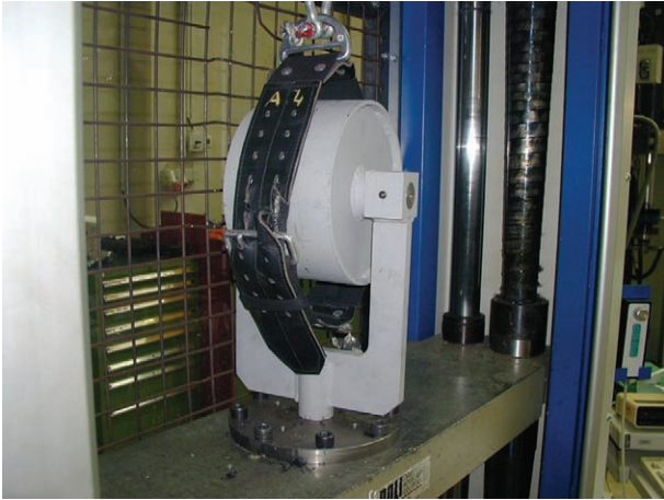
Haltegurt im Versuch, vor Erreichen der Mindestbeanspruchung
