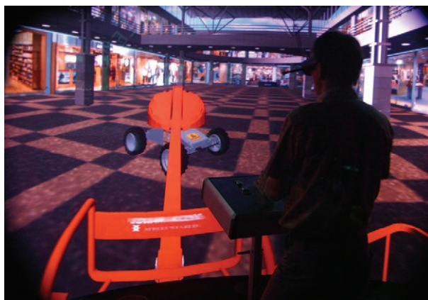
Im VR-Interaktionsraum des IFA: Hubarbeitsbühne für Arbeiten an einer Hallendecke
