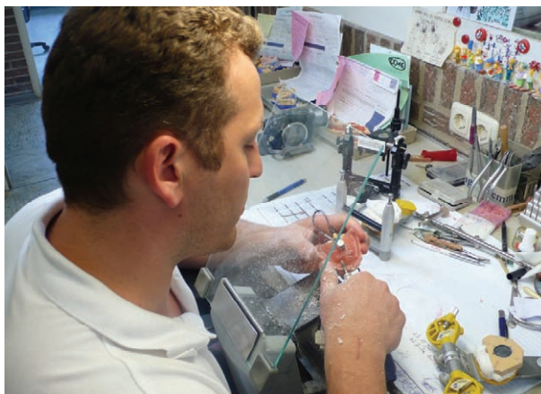
Messung der Hand-Arm-Vibration im Dentallabor
