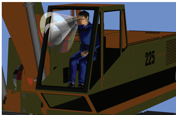
Virtuelle Ermittlung eines Sichtkegels bei einem Baumaschinenführer
