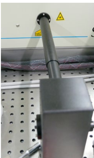
Abb. A9.1 Abgeschirmter Teil eines Ultrakurzpulslasers
