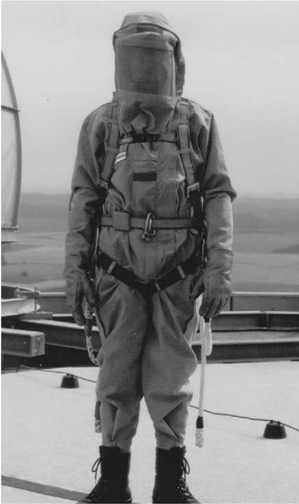
Das Anzugsmaterial ist durch metallische Beschichtung oder das Einweben von Metallfäden leitfähig. Das Gesichtsfeld der Kopfhaube kann aus einem Drahtgitter bestehen, sodass neben der ausreichenden Schirmwirkung auch ein ausreichender Luftdurchsatz zum Atmen gewährleistet ist [79 bis 81].
