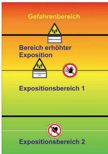
Nach BGR B11 „BG-Regel Elektromagnetische Felder“ [18] bedeutet „vorübergehende Exposition“, dass die Expositionszeiten im Mittel wesentlich kürzer als acht Stunden täglich sind, an fünf Tagen in der Woche bei 50 Wochen pro Jahr. Die zulässigen Werte sind unter dem Gesichtspunkt der Sicherheit gewählt. Sie orientieren sich an den Wirkungen von niederfrequenten und hochfrequenten Feldern. Die zulässigen Werte sind nach dem Vorsorgekonzept ausgewählt.
