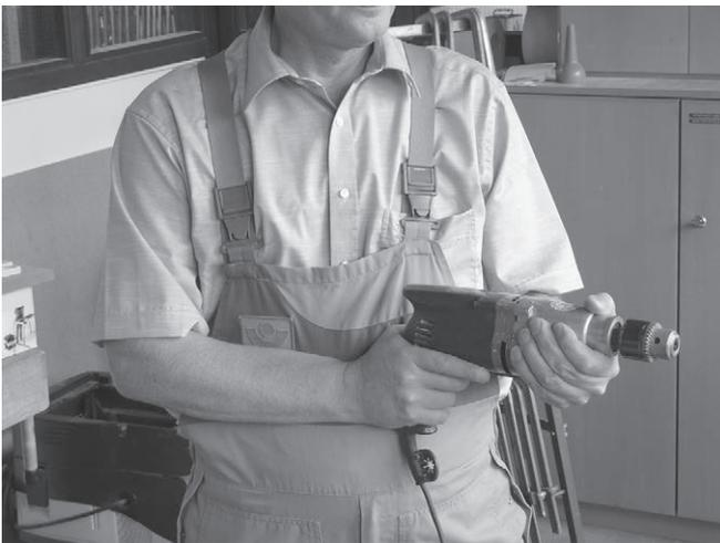
Überschreitet diese induzierte Spannung die vom Kardiologen individuell eingestellte Wahrnehmungsschwelle, kann dies zu einer Störbeeinflussung des Implantates und damit zu einer Gesundheitsgefahr für den Implantatträger führen. Um eine Störbeeinflussung ausschließen zu können, sollte der Implantatträger beim Arbeiten mit handgeführten Elektrowerkzeugen einen Sicherheitsabstand von etwa 40 cm oder etwa eine Unterarm-länge nicht unterschreiten.
