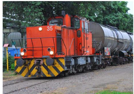
Am zweiten Tag wurden die Messungen beim Einsatz eines Lrf mit einem Triebfahrzeug DE 500 des Herstellers Kälble-Gmeinder (BASF 50, Abbildung 36) durchgeführt. Wie auch bei der ersten Messungen wurden vier Tätigkeitskategorien beobachtet (Tabelle 12 und Abbildung 38). Der Verlauf des Minuten- $L_{eq}$  ist in Abbildung 37 dargestellt. Der personenbezogene Mittelungspegel für die Messzeit wurde bei diesem Einsatz zu 85 dB(A) ermittelt.
