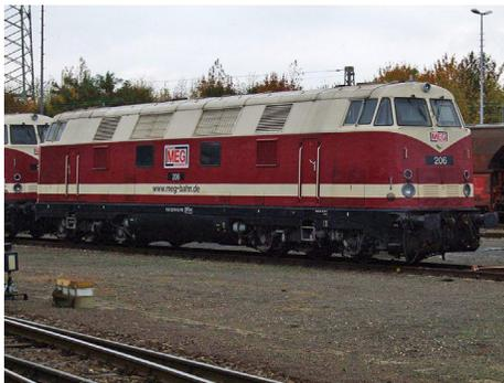
Auf dem Triebfahrzeug G 1206 BB (MEG 212, Abbildung 13) wurde die Lärmbelastung des EFF bei Streckenfahrten mit einem Kohlezug gemessen (leeren Zug zum Tagebau bringen, vollen Zug holen). Auf diesem modernen Triebfahrzeug ergibt sich mit 73 dB(A) eine deutlich geringere Belastung als auf dem zuvor beschriebenen Triebfahrzeug V 180 C'C' (Tabelle 4).
