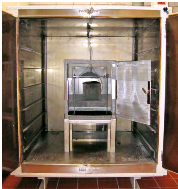
Bestimmung der Selbstentzündungstemperatur von Staubschüttungen
