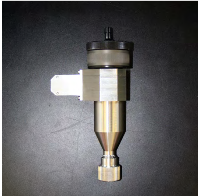
Zyklon für die Messung der thorakalen Fraktion bei Schwefelsäureexpositionen
