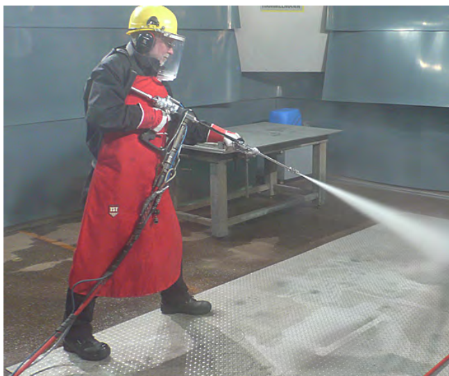
Messung der Hand-Arm-Vibration an einem Hochdruckreiniger
