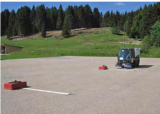
Vibrationsprüfstrecke mit Kehrmaschine
