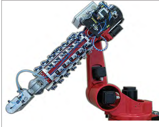
Prototyp einer Ultraschall-Schutzeinrichtung am Roboter
