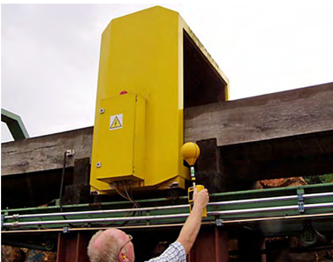
Messung der magnetischen Flussdichte an einem Metallsuchgerät
