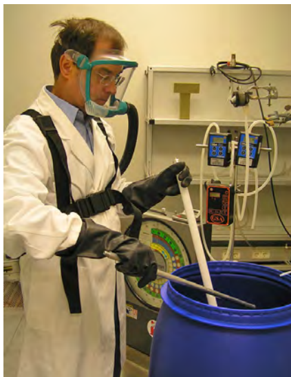
Nachstellung der Freisetzung von Quecksilberdampf aus Leuchtstoffröhren
