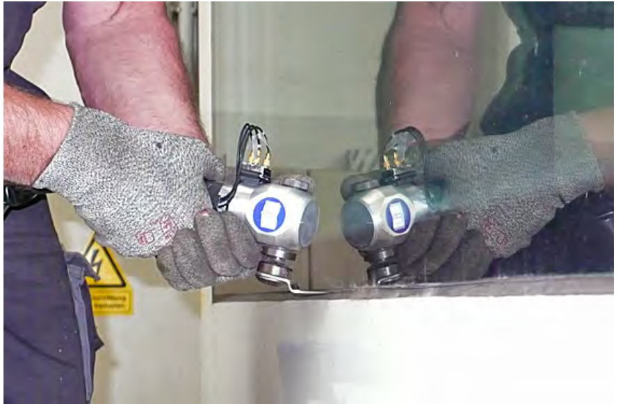
Messung der Hand-Arm-Vibration an einem pneumatischen Oszillationsmesser
