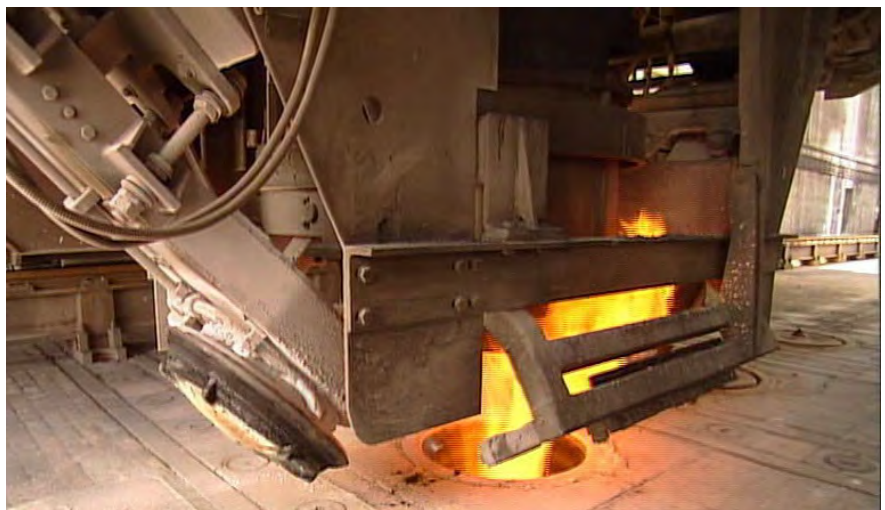
Füllwagen auf der Koksofendecke während der Beschickung eines Ofens (Bild: Thyssen Krupp AG)
