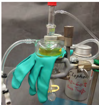
Prüfung von Handschuhmaterialien
