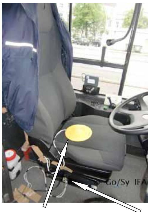
Beschleunigungsaufnehmer auf der Fahrersitzfläche und am Fahrersitzmontagepunkt
