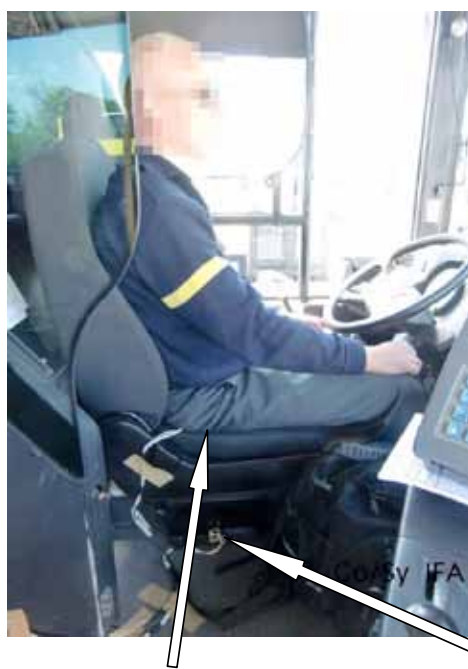
Beschleunigungsaufnehmer auf der Fahrersitzfläche und am Fahrersitzmontagepunkt
