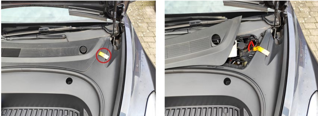
Abb. 21 Beispiel zur Position und Kennzeichnung der Steuerleitung
