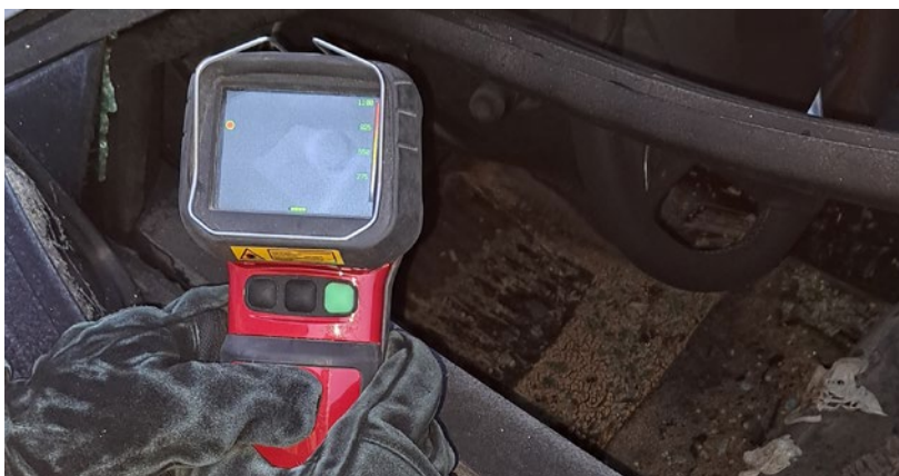
Abb. 24 Temperaturüberwachung mit Wärmebildkamera und QR-Code zum Temperaturmessprotokoll der vfdb e.V.
