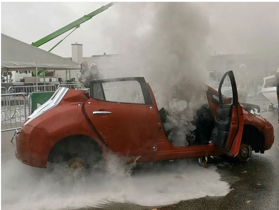
Abb. 17 Austretende Ventinggase aus Fahrzeugen mit HV-Speicher 14 (Neske, et al., 2025)
