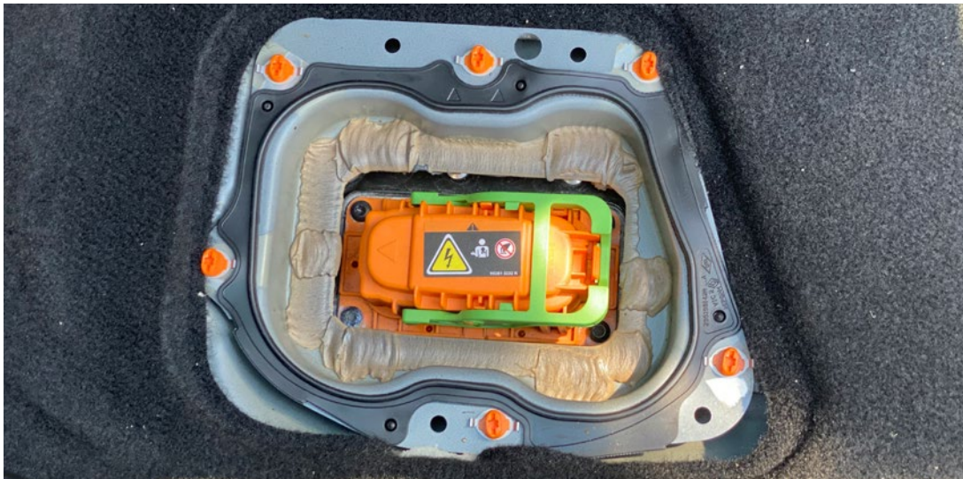
Abb. 23 Beispiel einer HV-Trennstelle ( service disconnect ) zur Deaktivierung des HV-Systems
