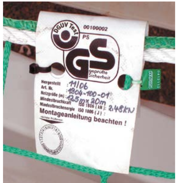
Abb. 4-13 Kennzeichnung mit Prüfnachweis
