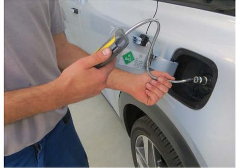
**Abb. 12** Nach Arbeiten an Tanksystemen werden Lecktester eingesetzt.
